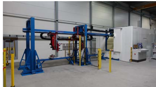
Abb. 3: Anlage zum Schweißen von unterschiedlichen Handtuchheizkörpern
